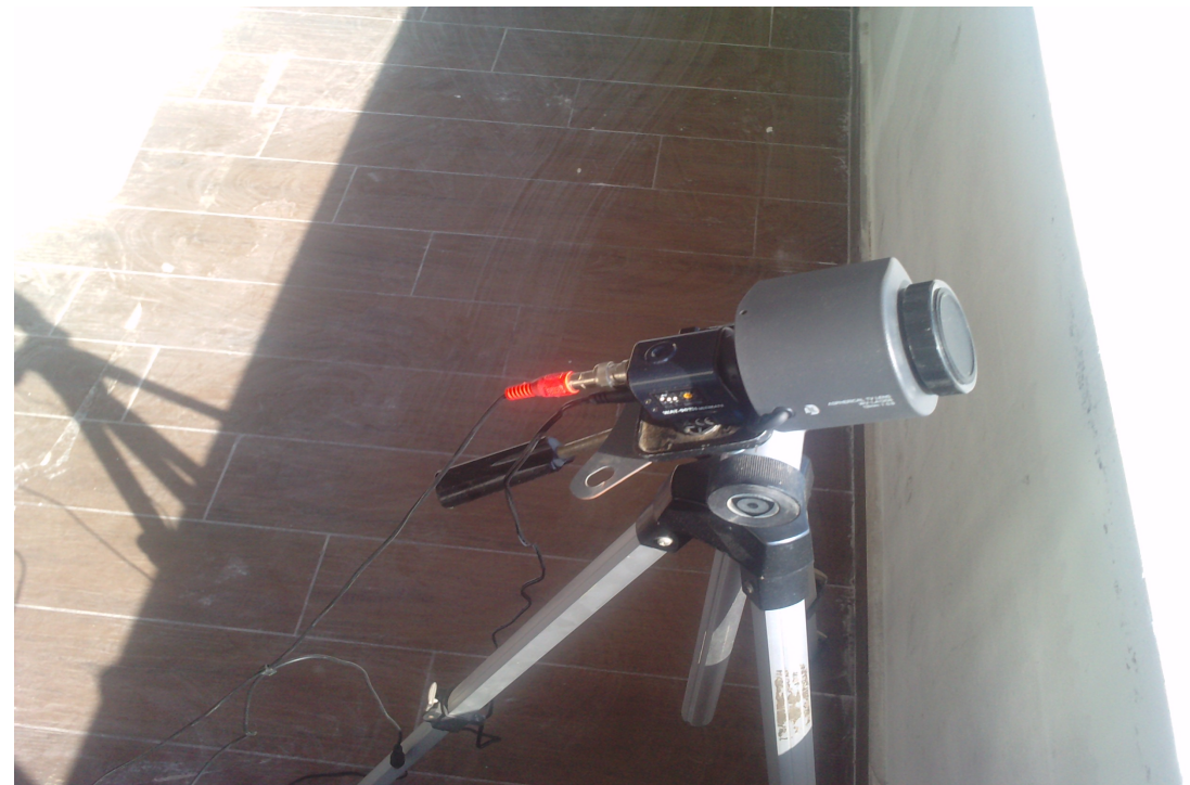
Εικόνα του συστήματος της Watec με τον φακό Panasonic (ο υπολογιστής που δεν φαίνεται “τρέχει” το MetRec).
